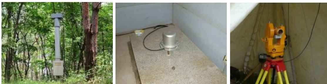
第2図. 測地観測所における地磁気観測機器（左：オーバーハウザー磁力計，中央：フラックスゲート磁力計，右：磁気儀）。
