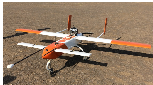
図 3. 航空探査のために開発した小型無人飛行機 Phoenix LR. 翼幅 3.2m, 120cc ガソリンエンジン 飛行速度 100km/h
