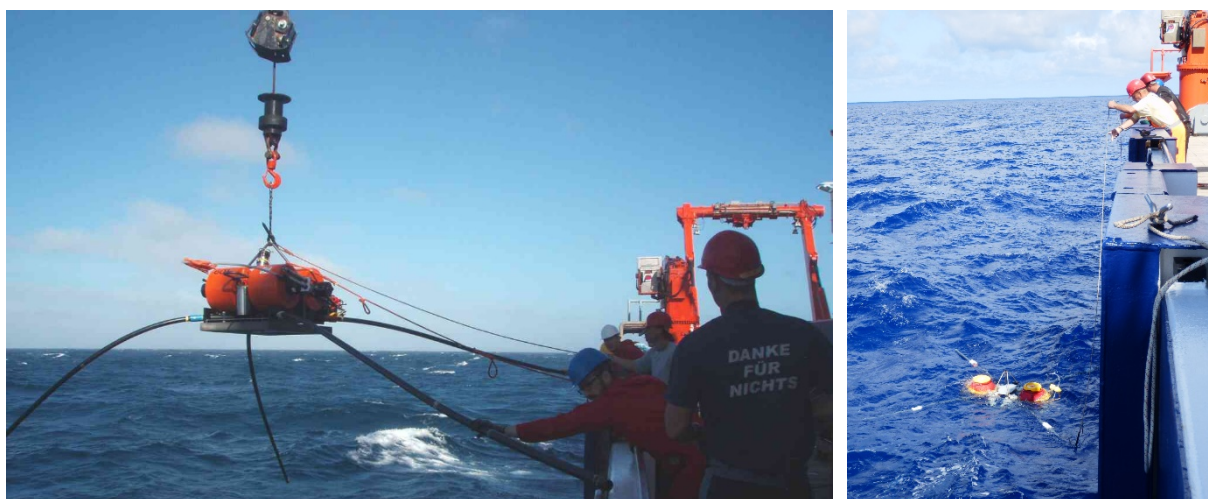
図 3. 左:設置航海にて GEOMAR の OBEM を投入する作業の様子。右:回収航海にて、地震研 OBEM を舷側で確保したときの様子。
