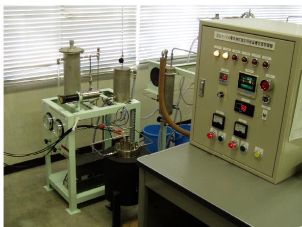
写真 1 比抵抗測定用高温高圧装置。
