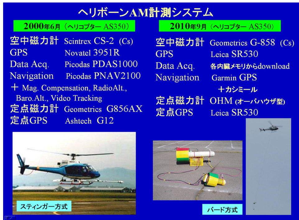
第1図 空中磁気探査に使用した機器材 Fig.1 Equipment used for aeromagnetic surveys of Usu Volcano in 2000 and 2010.
