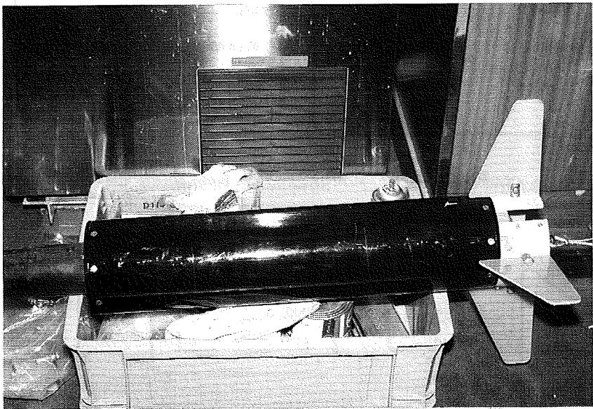
図3 ジオメトリクス社製プロトンセンサ。ダイヤフラム方式を使った圧力バランス方式で深度6000mまで使うことができる。センサ尾部にはセンサを安定させるために4つのフィンがつけられている。
